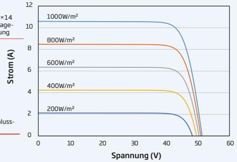
**P-V KURVEN DES PV-MODULS (430 W)**
